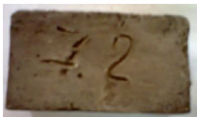
Рис. 4. Цвет керамического черепка при введении \text{MnO}_2 – 2 %
