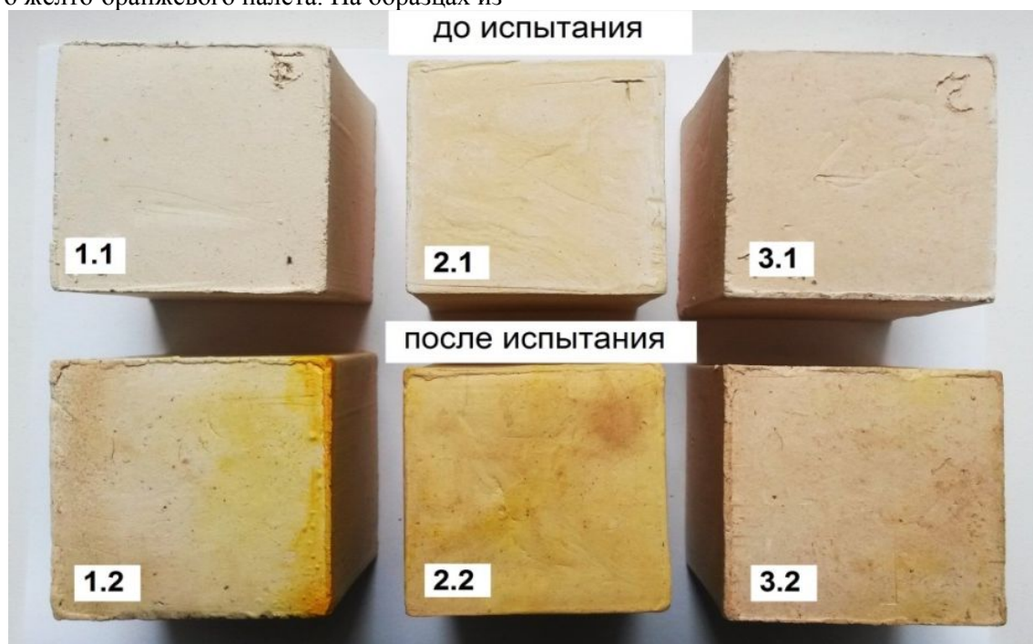
Рис. 4. Результаты определения склонности к высолообразованию на образцах: 1.1, 1.2 – БК-3; 2.1, 2.2 – ТЛ-3; 3.1, 3.2 – ЧП
