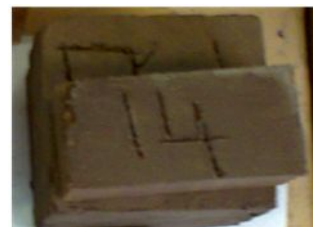
Рис. 5. Цвет керамического черепка при введении \text{MnO}_2 – 4 %
