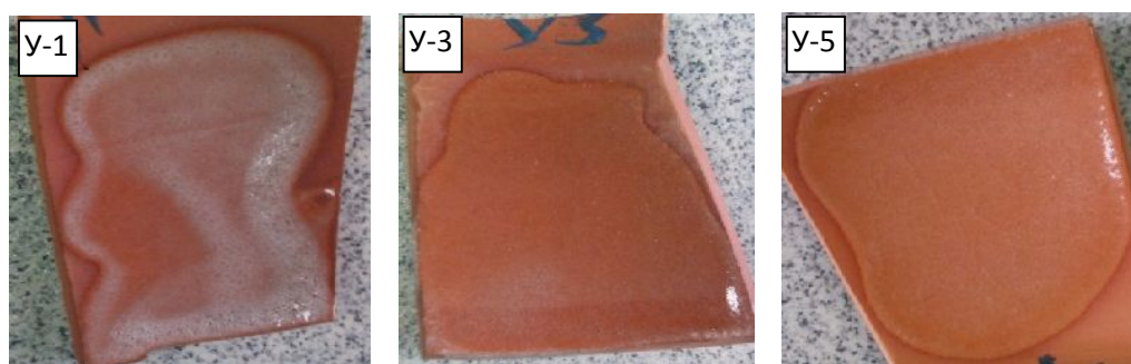
Рис. 4. Внешний вид черепков, глазурованных проектными составами с улекситом
