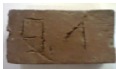
Рис. 4. Цвет керамического черепка при введении \text{MnO}_2 – 2 %
