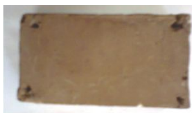
Рис. 4. Цвет керамического черепка при введении \text{MnO}_2 – 2 %
