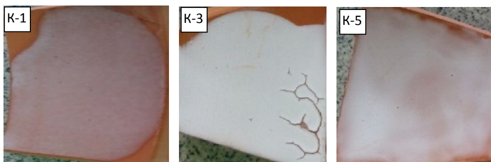
Рис. 5. Внешний вид черепков, глазурованных проектными составами с улекситом
